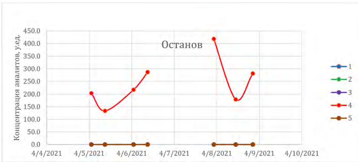
Рисунок 8—Концентрации газовых аналитов из 4 интервала скважины №XXX
